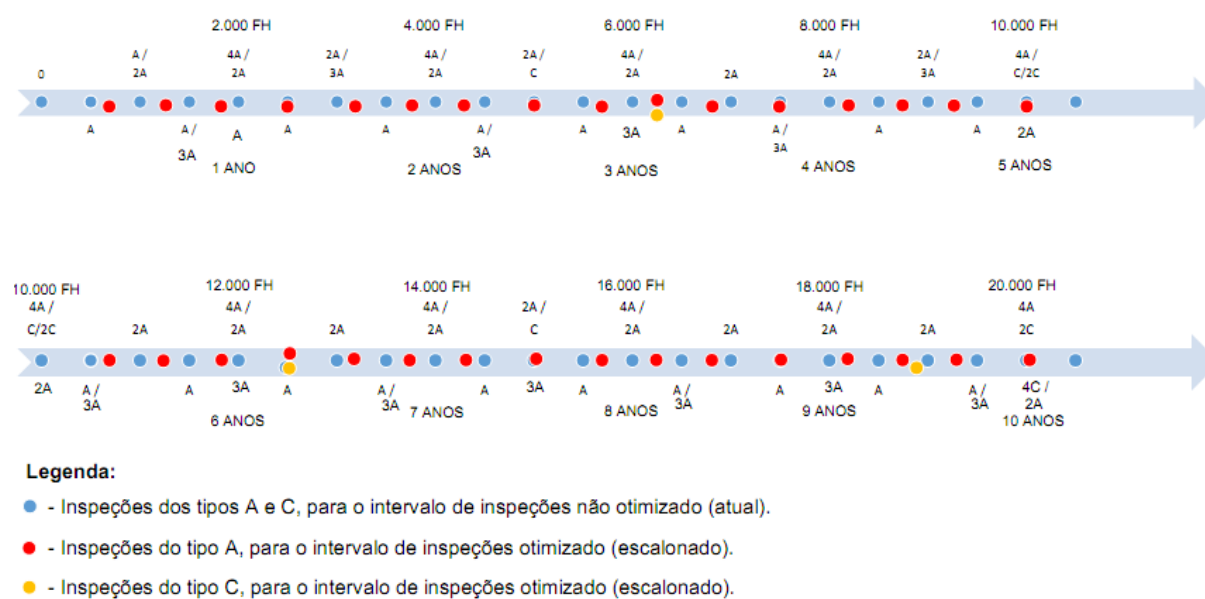
Figura 8 – Representação ilustrativa da linha do tempo das inspeções (checks) do tipo A e C, para o intervalo de inspeção não escalonado e escalonado
